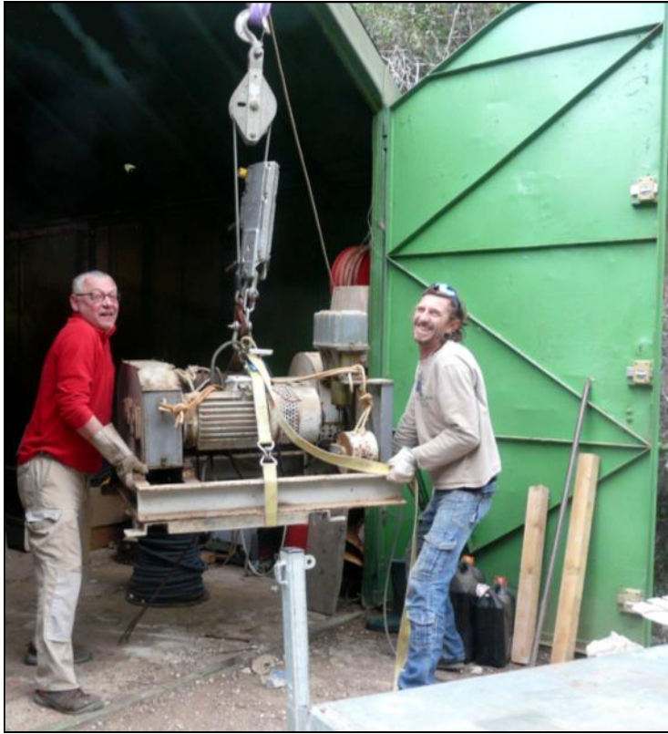
Francis Schira, alias Chouca, dans ses œuvres. Remplacement du vieux treuil, d'un poids de 400 kg. Les commandes de manœuvre ont été refaites et un nouveau générateur donne toute la puissance nécessaire.
